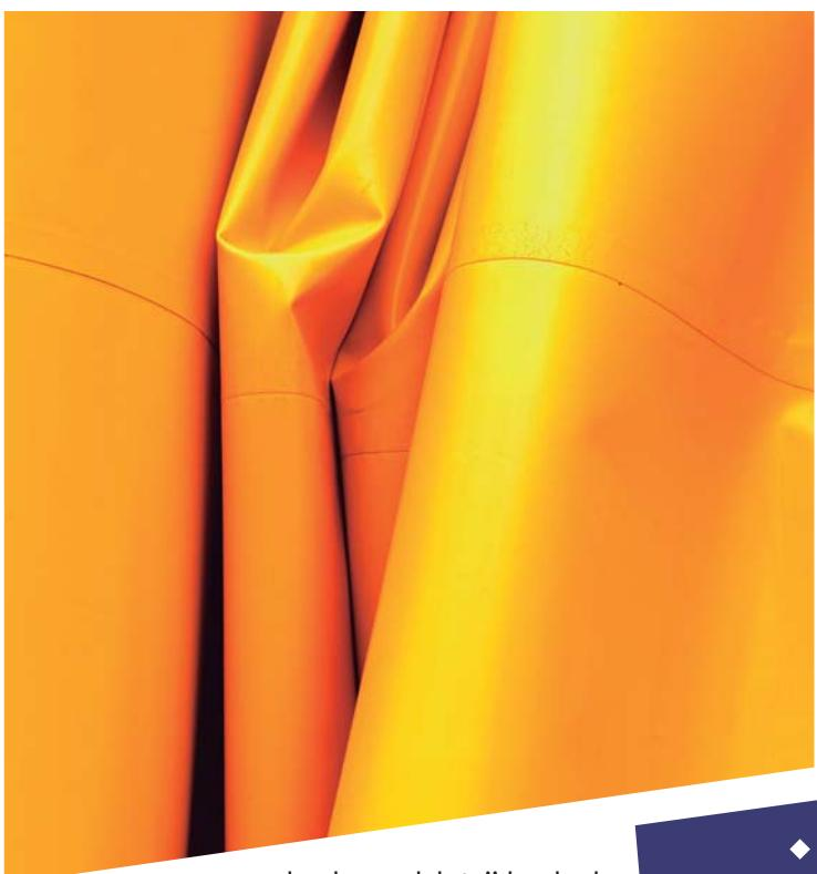
La base del tejido de la lona, realizada 100% en poliéster de alta tenacidad, está recubierta de PVC de alta calidad por ambas caras, y posteriormente esta recubierta de una capa de laca brillante de protección también en ambos lados. Este hecho le confiere más durabilidad facilita la limpieza y ayuda a que los agentes externos como polvo y tierra resbalen y no se adhieran al tejido.
