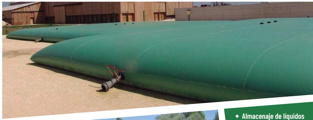
El tejido técnico GAMMA 12 CPF es ideal para la **confección de depósitos para el almacenamiento de líquidos ligeramente ácidos** (consultar de compatibilidades). La formulación utilizada para la fabricación del PVC de alta calidad le confiere esta propiedad. La estructura del tejido base 100% poliéster de alta tenacidad, junto al gramaje de la lona (1300 g/m<sup>2</sup>) hacen de esta un producto muy resistente, con **gran adherencia y durabilidad**.
